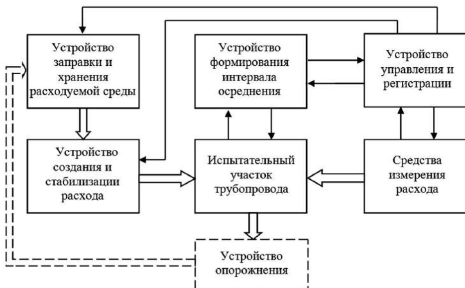
Рисунок 1. Общая структурная схема ИРУ газа
