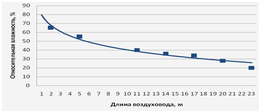
Рисунок 2. Изменение относительной влажности в воздуховоде
