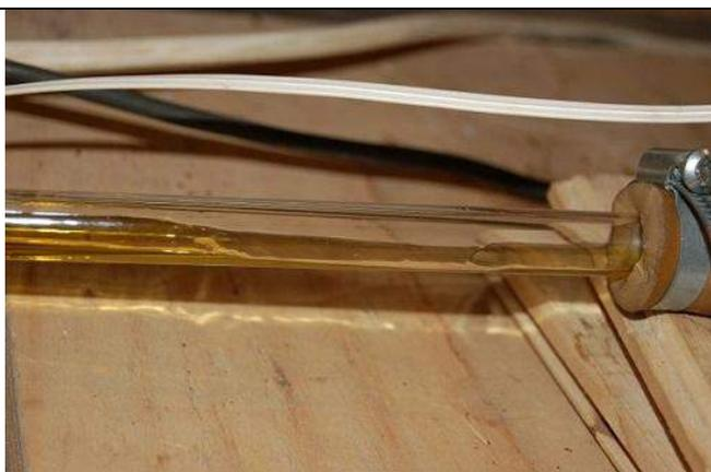
**Рисунок 6.** Фотография стока конденсата на участке RQ (внутри холодильной камеры) при работающем устройстве.
