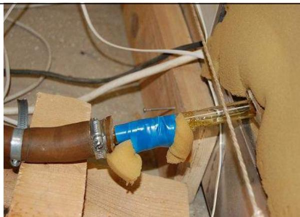
**Рисунок 5.** Фотография стока конденсата на участке HP (до входа в холодильную камеру) при неработающем устройстве.
