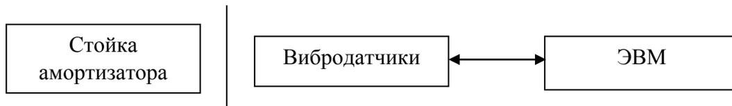
Рисунок 1. – Структурная схема диагностической системы
