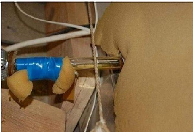
**Рисунок 4.** Фотография стока конденсата на участке HP (до входа в холодильную камеру) при работающем устройстве.
