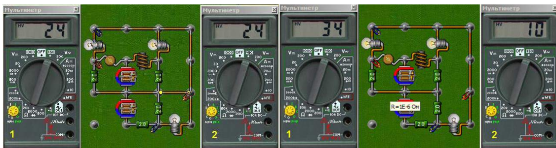
Рисунок 8. Схема и измерения в случае перекаса «фаз» (а), с присоединённой нейтралью (б).
