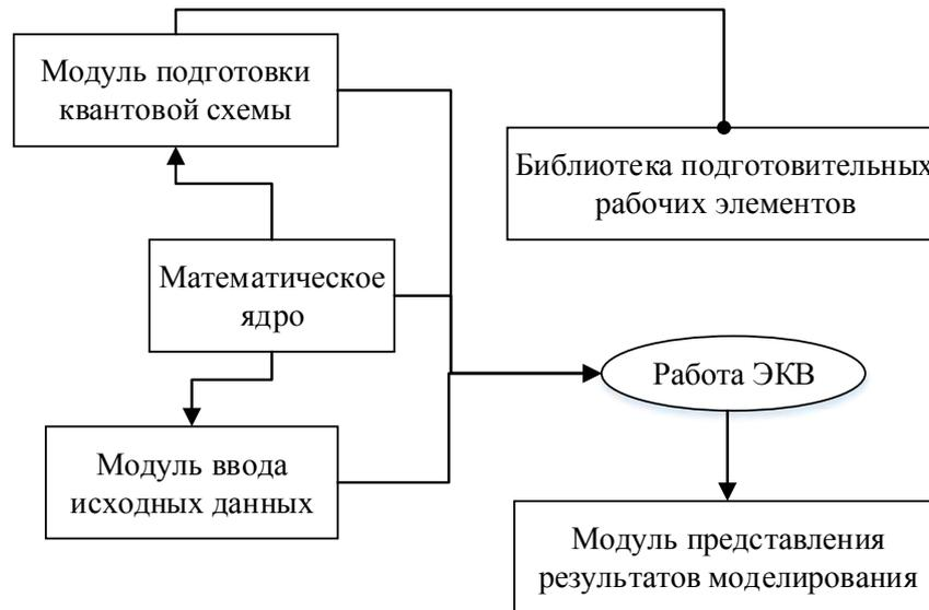
Рисунок 1. Модульная структура модели квантовых вычислений
