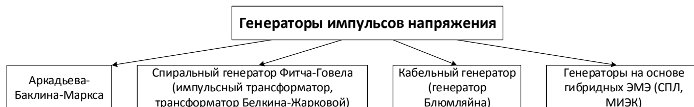
Рисунок 2. Классификация ГИН по схмотехническому исполнению
