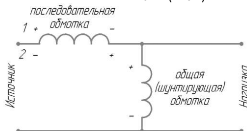
Рис.1 Принцип работы вольтодобавочных трансформаторов
