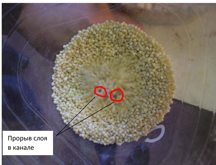
Рисунок 1. Формирование канала в тонком слое зернистого шарообразного материала
