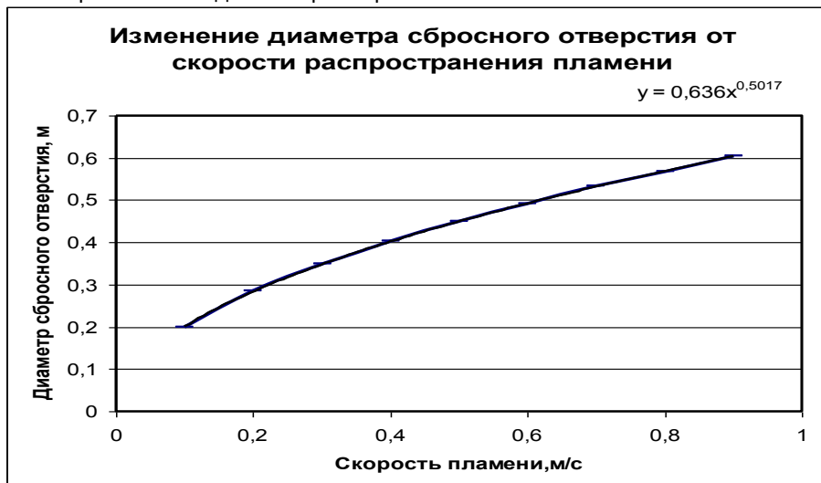
Рис. 1. Зависимость изменения диаметра сбросного отверстия взрывного клапана от скорости распространения пламени паров ацетона в цилиндрическом сосуде диаметром D=1,8 м и высотой H=4 м.
