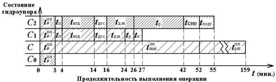
Рисунок 3. Временная диаграмма реализации операции контроля состояния гидроупора вертолёта Ми-8 при оперативном техническом обслуживании
