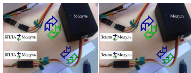
Рис.8. Подключение модуля шифрования (шифратора) к бортовой и наземной аппаратуре
