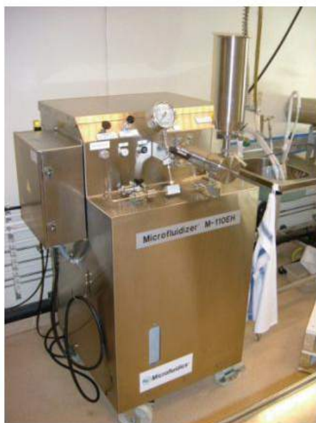
Рисунок 5. Микрофлюидизер M-110-EN и схема устройства камеры взаимодействия.
