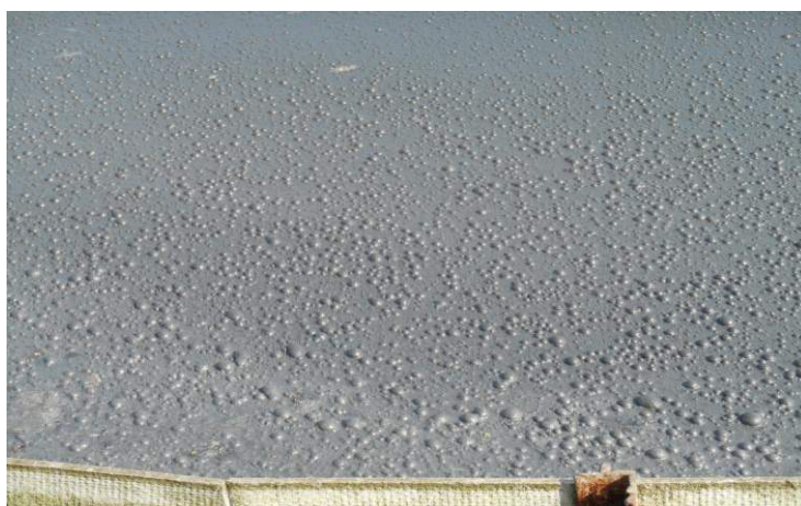
Рисунок 2. Выделение газа в процессе ацидофикации
