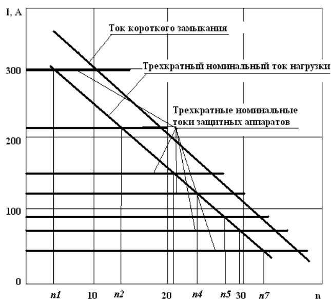
Рисунок 1. Распределение токов короткого замыкания и токов нагрузки в узлах линии электропередачи
