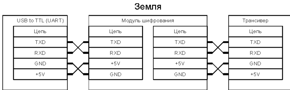
Рис.5. Схематическое изображение подключения шифратора в разрыв между наземной станцией и трансивером
