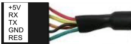
Рис.2. Внешний вид разъема UART
