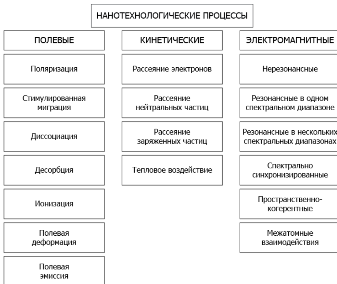
Рисунок 1. Перечень классифицированных физических эффектов, используемых в нанотехнологических процессах
