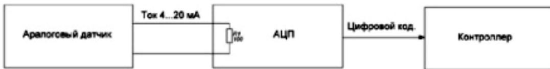
Рисунок 2. Упрощенная схема подключения датчика с выходным аналоговым сигналом к контроллеру
