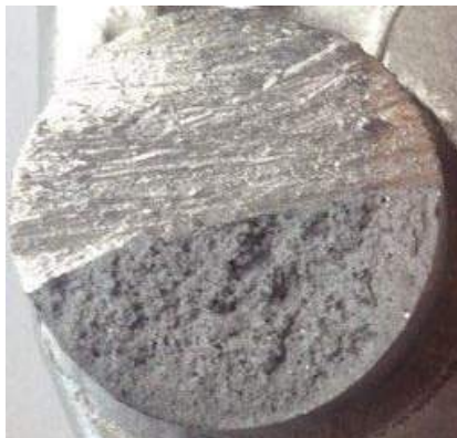
Рисунок 2 – Излом композита Al-TiC, полученного с применением термита.
