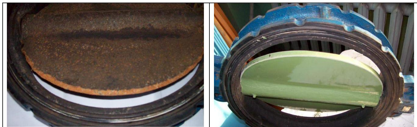
Рисунок 4 – Поворотный затвор ДУ 400 до и после восстановления.
