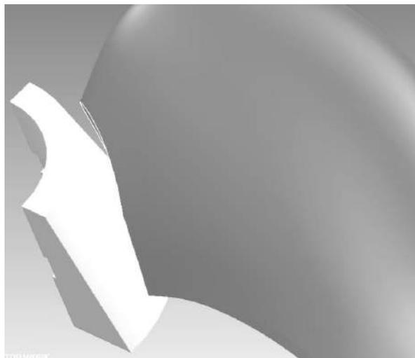
Рисунок 2. Зазор между пером лопасти и ступицей
