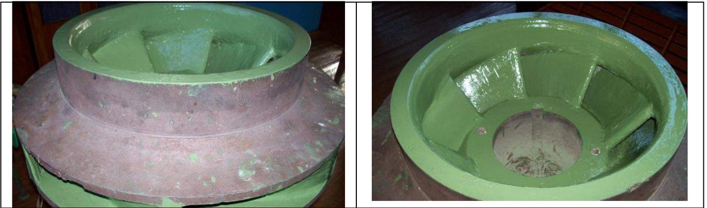
Рисунок 6 – Восстановленное материалом ННК ДК-2 рабочее колесо центробежного насоса ЦН 3000-197
