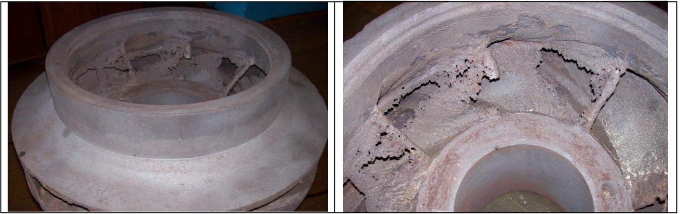
Рисунок 5 – Изношенное состояние рабочего колеса центробежного насоса ЦН 3000-197
