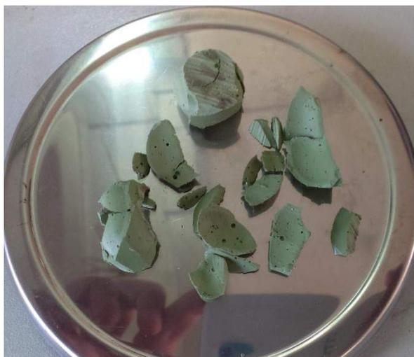
Рисунок 3 – Влияние растворителя 746 на образец из полимерного материала ННК ДК – 2.
