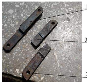
1 - Образец стальной; 2- Отверстие для фиксации; 3- Слой полимера.
