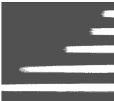
Рисунок 4. Вид свечения разряда под ПЭ при различных амплитудах импульсного потенциала.
