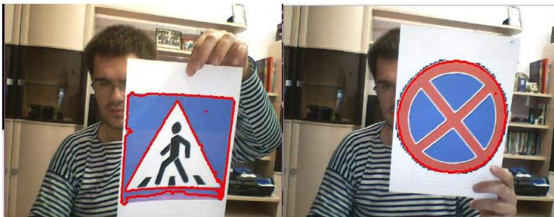
Рисунок 2. Работа алгоритма детектирования с алгоритмом Лукаса-Канаде
