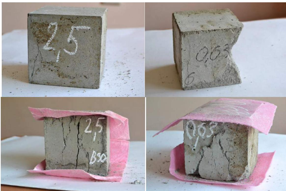
Рис. 5. Внешний вид образцов из бетона В30, испытанных в стандартных и в условиях гидродинамического трения: а) без прокладки, заполнитель – песок фракции 0,67...2,5мм; б) без прокладки, заполнитель – песок фракции  $\leq 0,67\text{мм}$ ; в) с прокладкой, заполнитель – песок фракции 0,67...2,5мм; г) с прокладкой, заполнитель - песок фракции  $\leq 0,67\text{мм}$  мм.
