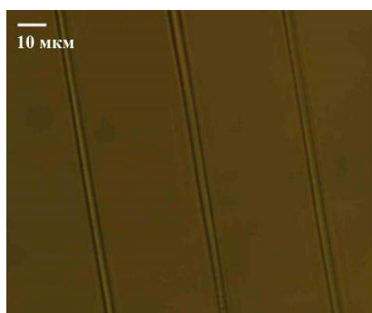
Рис.1. Микрофотография высококонтрастных структур в объеме стекла состава 0.5Li 2 O-0.4P 2 O 5 -0.1Nb 2 O 5 .
