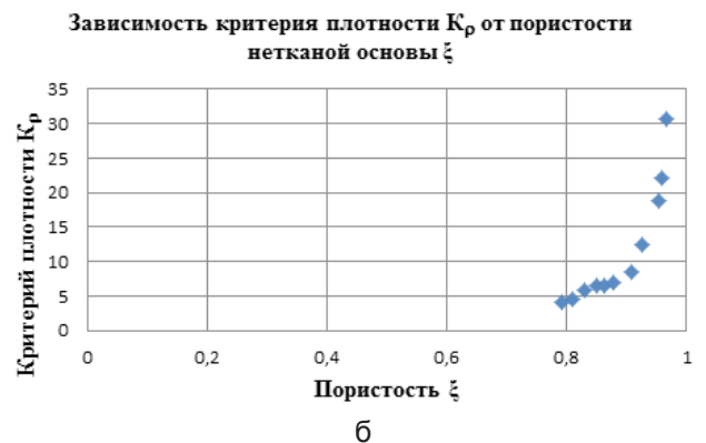
Рис. 2. Зависимость от пористости нетканой основы \xi : а - критерия сжатия K_{\delta} ; б - критерия плотности.
