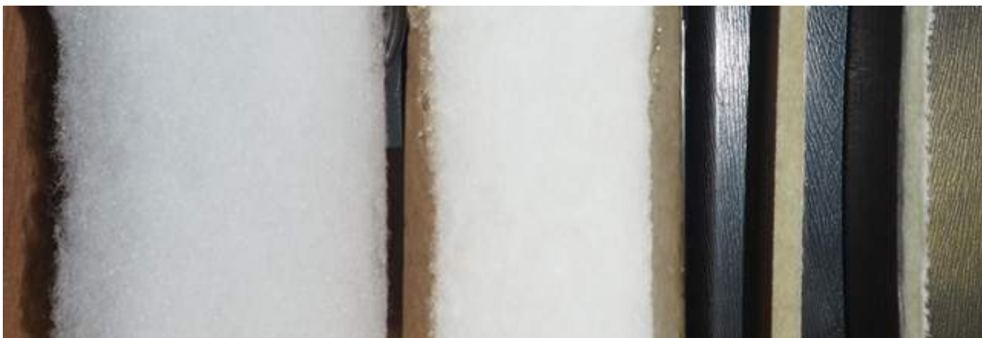
Рис. 1. Толщина образцов нетканого полотна марки «Холлофайбер хард» и изделий из композитов на его основе: а – исходное нетканое полотно, толщина 60,74 мм; б – тепло-звукоизоляционная панель (самопроектируемая пропитка), толщина основы 49,80 мм; в – пластина композиционного материала (вакуумная пропитка), толщина 6,52 мм; г – нетканая составляющая многослойного композита (середина, вакуумная пропитка), толщина 6,11 мм.
