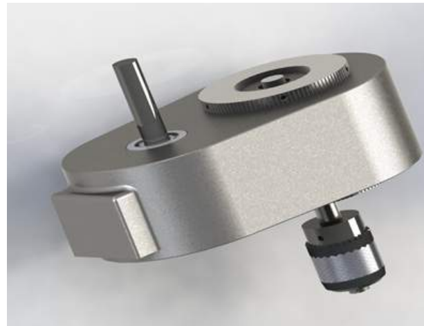
Рисунок 4. Трехмерная модель комплекса для реализации сверления с наложением вибраций
