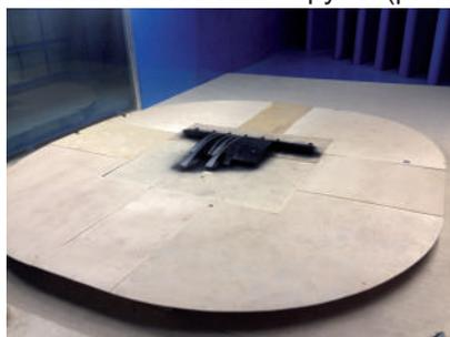
Рисунок 2. Модель аэропортового комплекса в рабочей зоне аэродинамической трубы МГСУ
