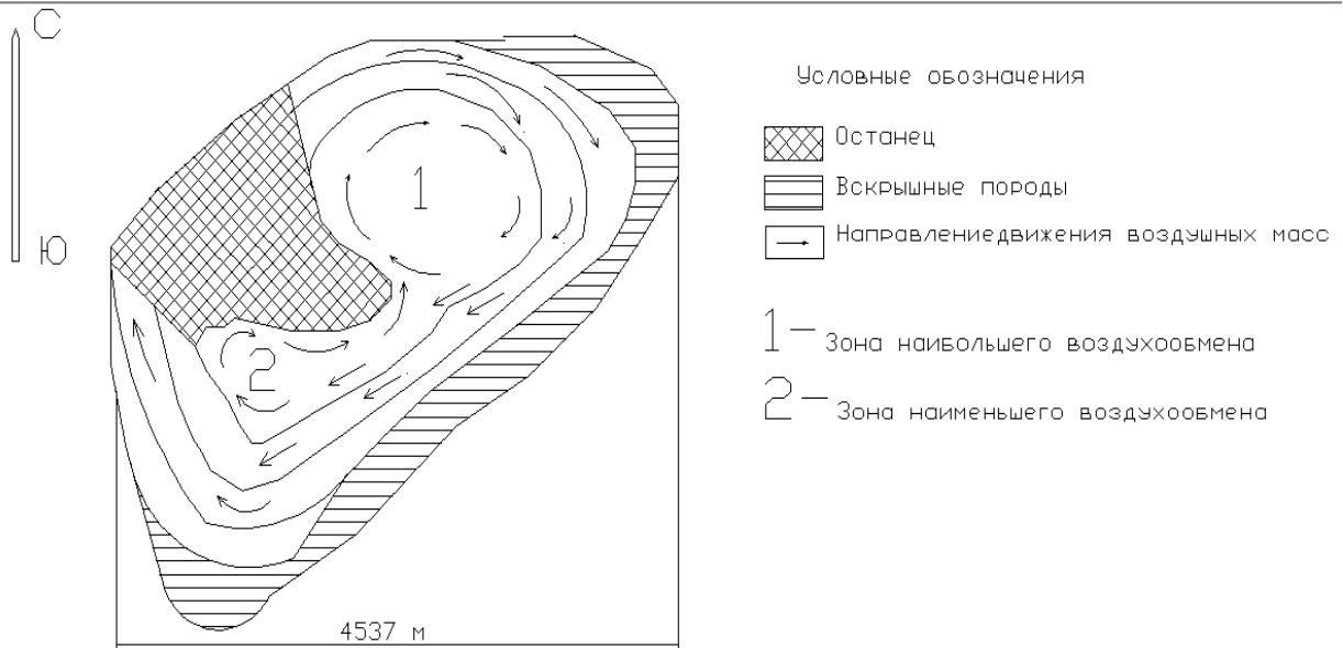
Схема 1. Формирования воздушных потоков в Лебединском карьере СГГДК КМА
