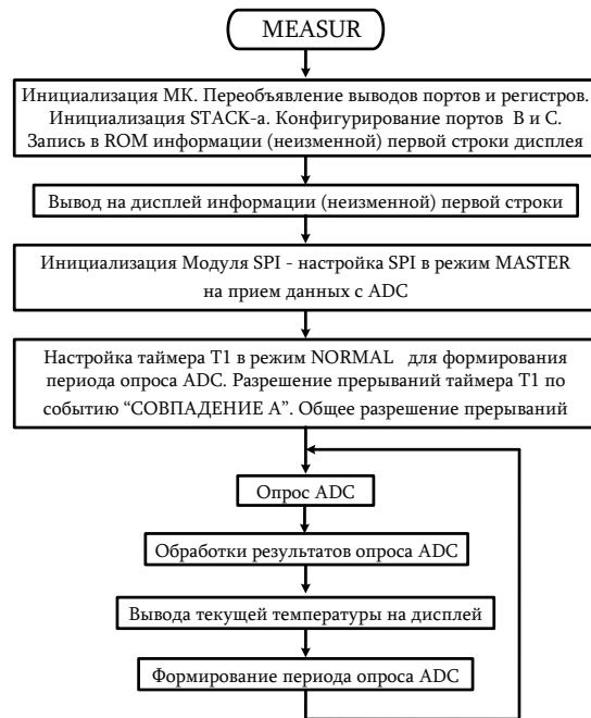
Рис.4. Блок-схема алгоритма программы обработки результатов измерения
