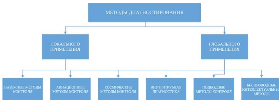
Рисунок 1. Условное деление методов диагностирования
