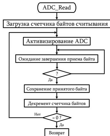
Рис.5. Блок-схема алгоритма подпрограммы считывания ADC
