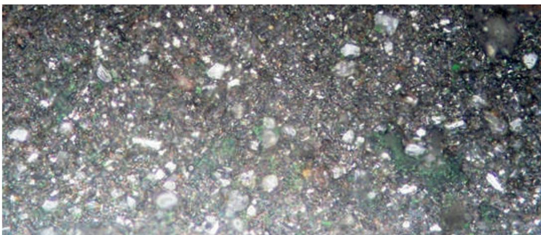
Рисунок 2. Структура слоя спеченного графита, имплантированного наноалмазами (x500)
