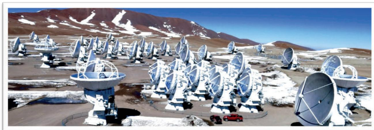
Рис. 2а. Современный радиотелескоп с синтезированной апертурой ( множество радиоантенн работают как один телескоп большого размера) в Андах для прослушивания далекого космоса. Обратите внимание на размеры зеркала антенны по сравнению с автомобилем (на переднем плане).
