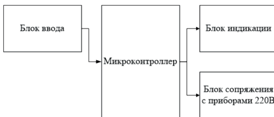
Рисунок 1 – Структурная схема многоканального таймера
