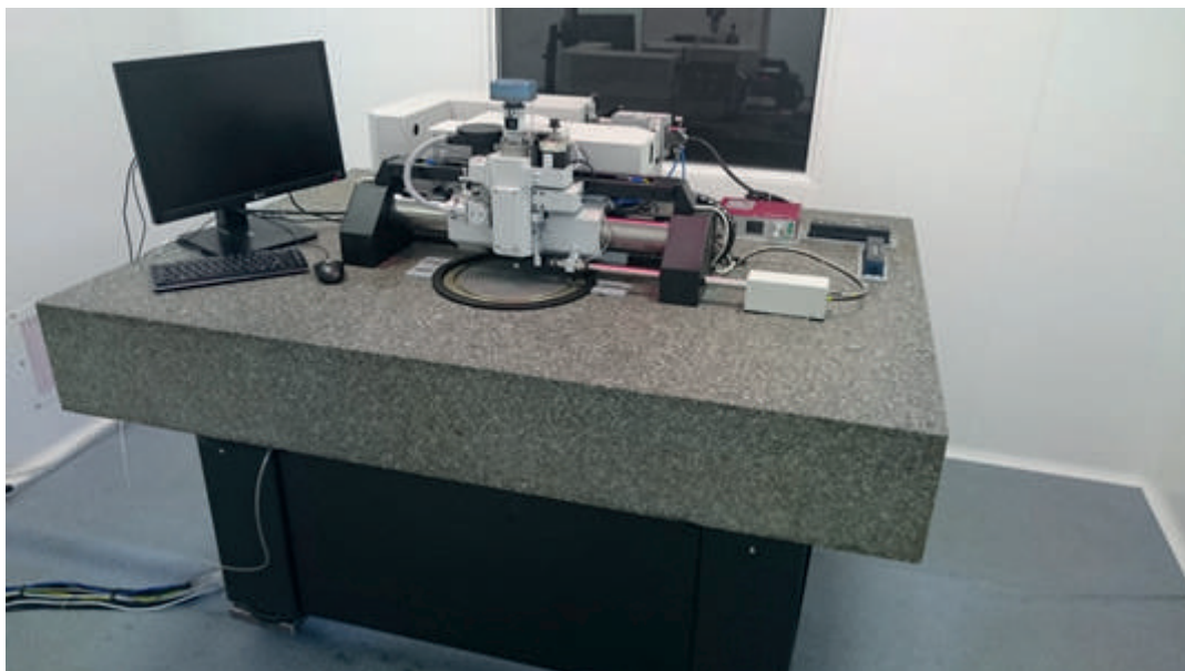
Рис.2 Установка прямой лазерной записи
