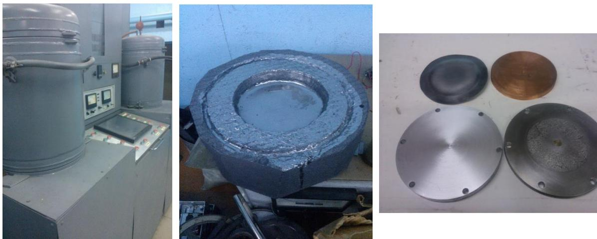
Рисунок 1 - Двухколпачковая вакуумная печь (а), графитовая форма для плавки металла (б), вид мишеней, полученных методом вакуумной плавки (в).
