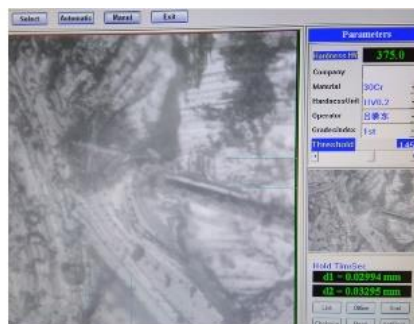
Рисунок 2 – Микротвердость без покрытия (а) и с покрытием (б)
