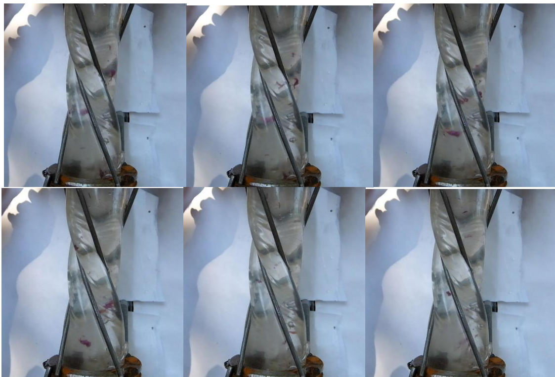
Рисунок 2 – Закручивание потока в периферийном канале, образованном шлангом и стержнями
